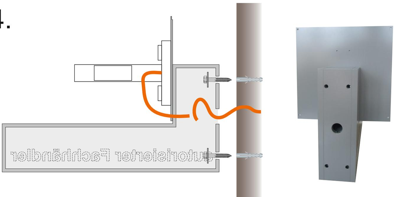
Unterteil mit entsprechendem Befestigungsmaterial (nicht enthalten) an der gewünschten Stelle auf den Untergrund montieren. Installationsträger (Anschlussfertig für 230V) an Bauseitige **Zuleitung** der Netzspannung (230V) anschließen.
