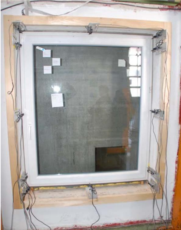
**Bild 1** Probekörper Bauteilprüfung, Ansicht von der Raumseite
