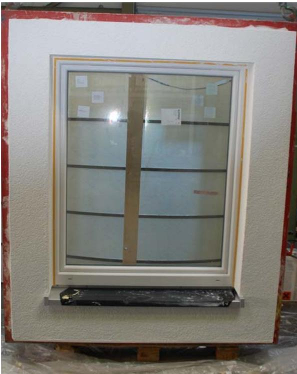
**Bild 1** Probekörper Bauteilprüfung, Ansicht von der Außenseite
