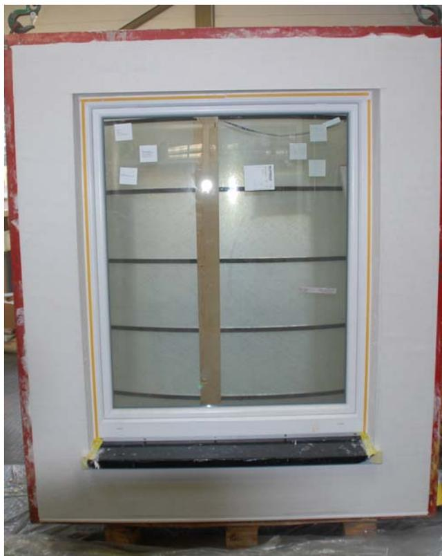
**Bild 4** Probekörper mit ausgeführtem Armierungsputz.
