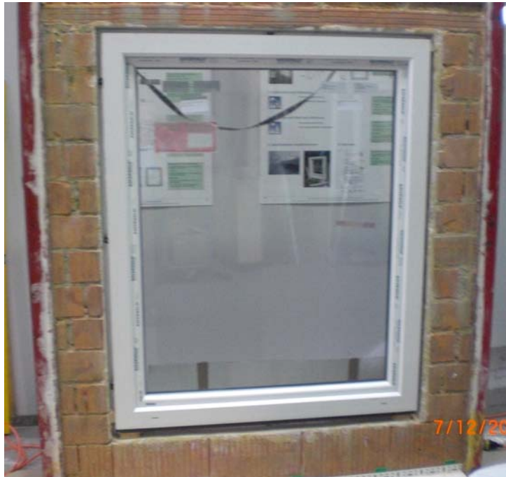
Bild 1 Probekörperherstellung. Im ift vorbereitet: Stahlrahmen mit Ziegelmauerwerk und Kunststofffenster bündig zur Mauerkante gesetzt.
