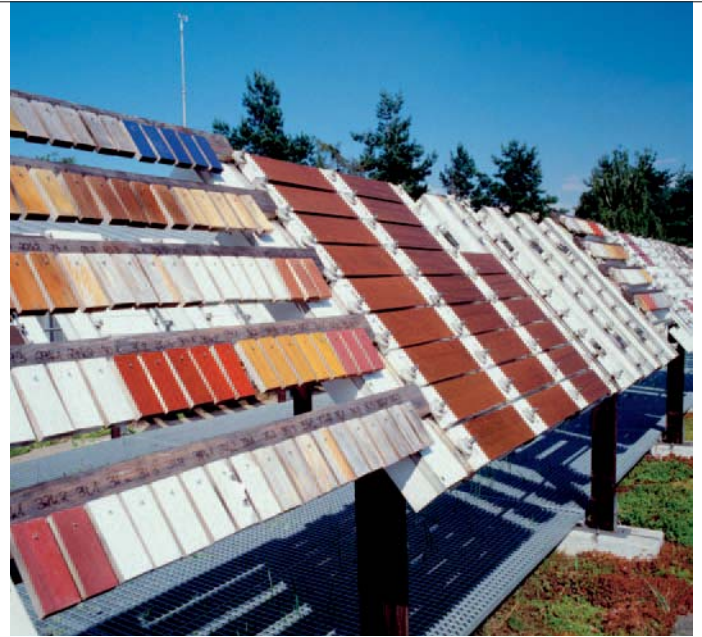
Beschichtete Kiefernspiltholzträger beim Freibewitterungstest des Wilhelm-Klauditz-Instituts. Die Versuchsanordnung simuliert eine Normalbewitterung von etwa 5 Jahren.
