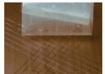
Gute Haftung: selbst bei starker mechanischer Einwirkung bleibt die Beschichtung unversehrt.
